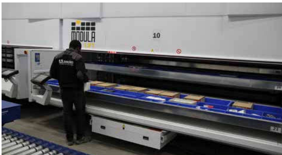
Medewerkers hoeven niet meer te bukken of te reiken, aangezien de trays op ergonomische werkhoogte worden gepresenteerd.
