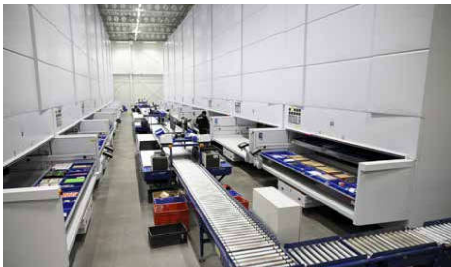
In de nieuwe hal staan de 24 Modula-liften opgesteld in drie rijen van acht. Een rollenbaan verzorgt het transport van klantenbakken.
