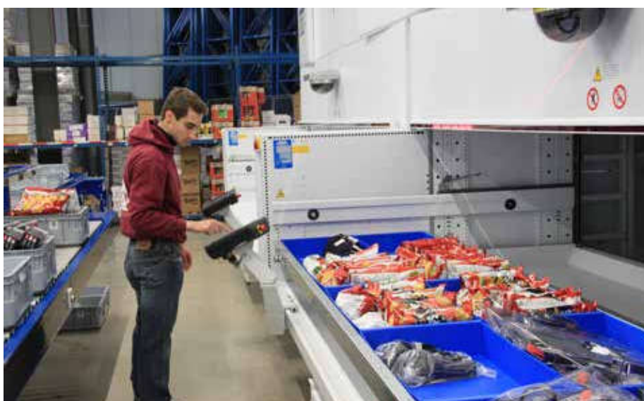
Aan de Modula-liften wordt de operator geassisteerd door een grafische LED-bar en een laserpointer die de plaats van het te picken artikel op de tray aangeeft.
