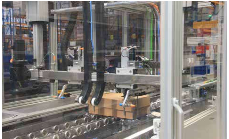
Is een order klaar, dan gaat de bak richting de verpakkingmachine. Daar wordt het volume van het complete order automatisch berekend en op basis daarvan wordt just-in-time een verpakking op maat rond de producten van één order gevouwen.
