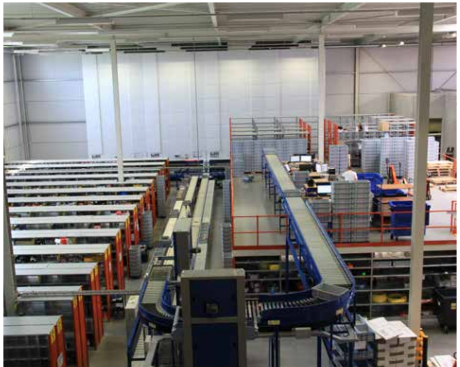
Alle artikelen met een beperkt formaat – en dat zijn er erg veel – krijgen in het nieuwe logistiek centrum ofwel een plaats in de legbordstellingen ofwel in de vier verticale liftsystemen van Modula.
