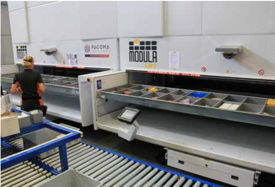
Door de combinatie van de verticale liftsystemen, de legbordstellingen en de conveyors kan Bus Industrial Tools snel orders verzamelen. Aan de verticale liftsystemen kan één orderpicker tot 300 picks per station halen. Er zijn twee pickstations voorzien aan de vier Modula-liften.
