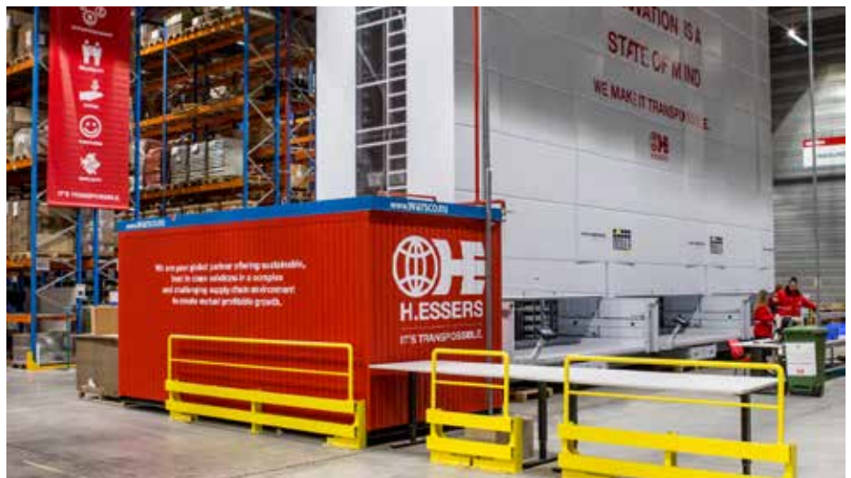
Op de site van H.Essers in Genk kwamen uiteindelijk drie Modula-liften met 15.000 locaties van verschillende grootte, verdeeld over ongeveer 210 platformen.
