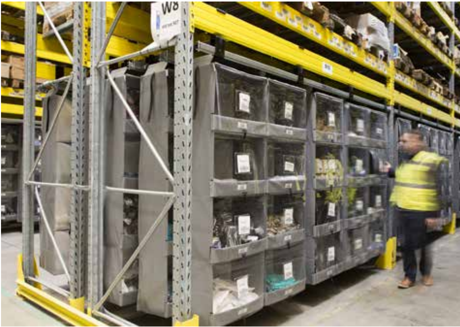
Typisch aan heel wat van de magazijnen van H.Essers is dat er heel veel rekken in staan. Een Storeganizer-systeem bestaat uit zogenaamde slabs, die vlot geïntegreerd kunnen worden binnen bestaande palletlocaties in het rek.
